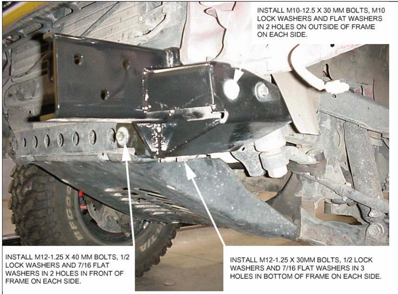
**FIGURE 1, FRAME BRACKET INSTALLATION.**
